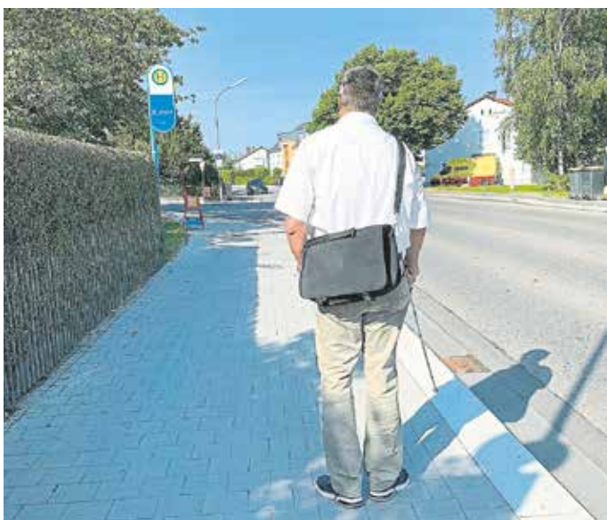
Bushaltestellen sind nicht barrierefrei (beispielsweise ist unter anderem kein Blindenleitsystem vorhanden)
